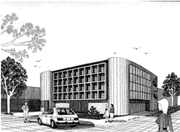
El cristal, que por sus características en cuanto a transparencia y reflectancia se refiere, puede causar cierta dificultad en su representación gráfica, se ha trabajado en esta perspectiva de un edificio visto desde el exterior a base de líneas vibradas con diferentes distancias unas de otras en sentido vertical, logrando de esta manera el efecto deseado.
