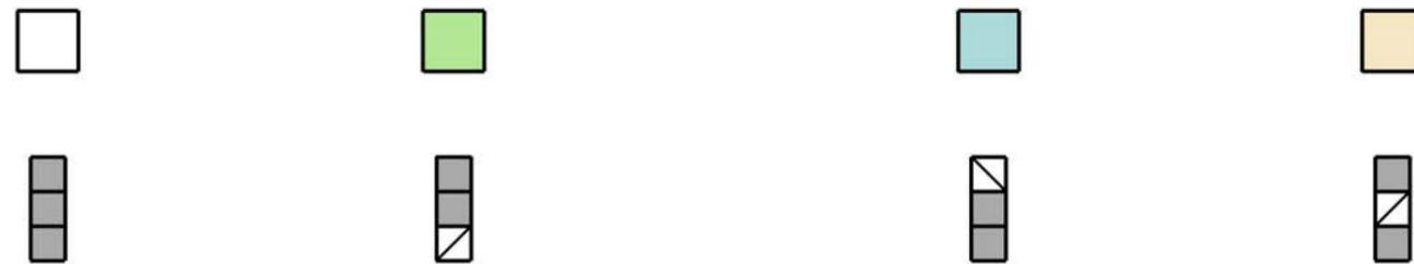
Dibujar todas las vistas del sólido, partiendo de la vista en planta y la información de alturas. A cada color le corresponde una configuración de altura específica. Cada cubo mide 3 mt de lado, así que el volúmen tiene 9 mt de altura, 18 mt de largo y 9 mt de profundidad. Dibujar con mayor grosor los contornos de los elementos más cercanos
